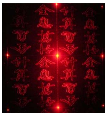
图 6.3 分别写有“计算”和“全息”两字的全息图旋转合并后的再现像
